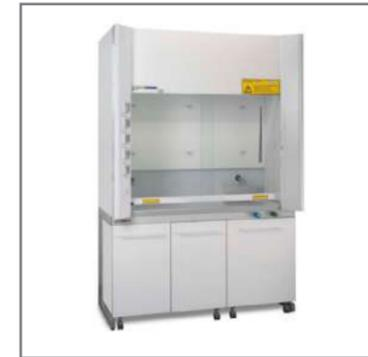
Manipulation sans danger des produits chimiques qui dégagent des vapeurs ou poudres nocives voire toxiques. Équipée d'un filtre moléculaire et/ou d'un filtre particulaire.
